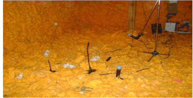
Fig.8. La disposition des microphones dans la chambre sourde
