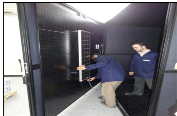
Fig.5. Test d'un module SM55 au niveau du simulateur
