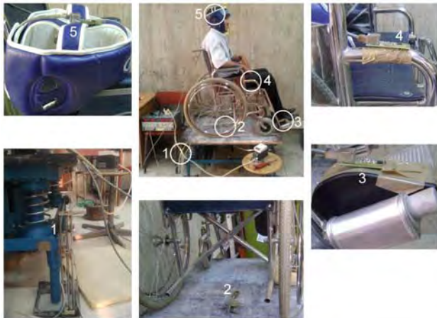
Fig. 4. Installation des accéléromètres et du capteur de position aux différents endroits de mesure : (1) capteur de position ; (2) Acc-T; (3) Acc-F; (4) Acc-W ; (5) Acc-H.
