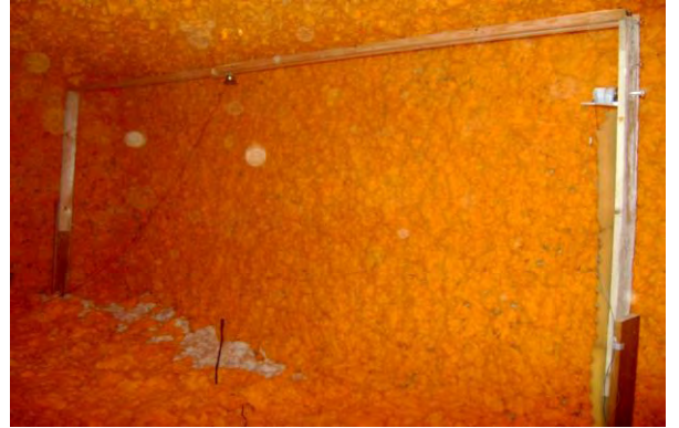
Fig.2. La plateforme construite en chambre sourde
